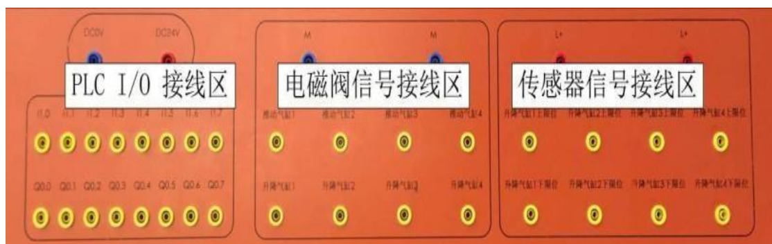
图 A-16 PLC 的 IO 信号接线区域
